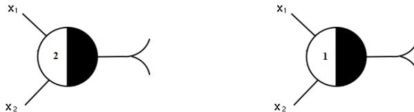
Abbildung 3: McCulloch–Pitts–Zellen zur Berechnung der AND und OR Funktion.
