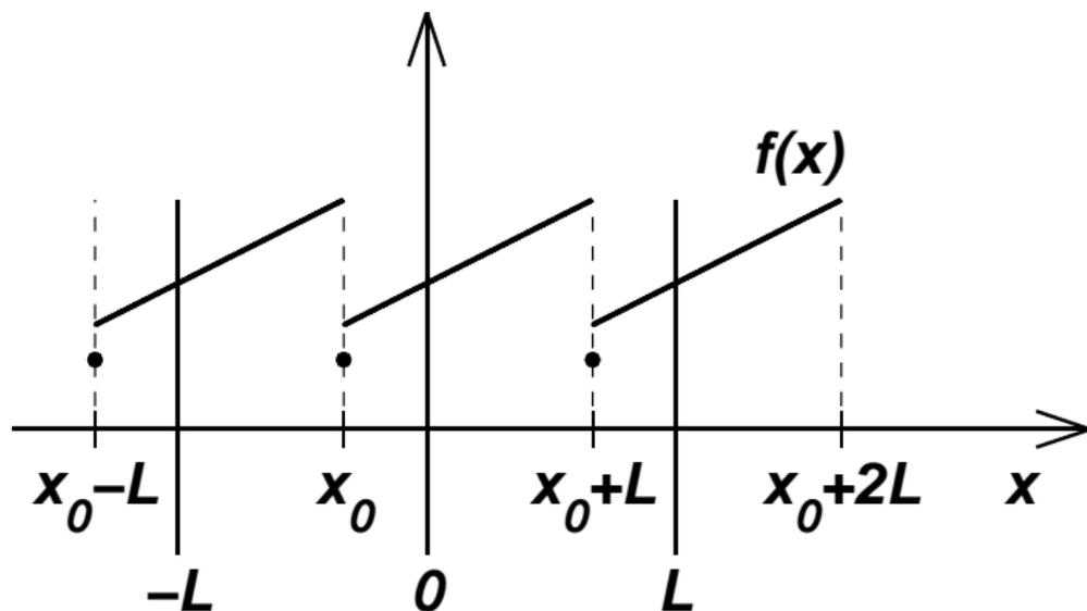
Abbildung 3.20:  $L$ -periodische Funktion mit Periodizitätsintervallen  $[x_0 + kT, x_0 + (k + 1)T]$ ,  $x_0 \in \mathbb{R}$
