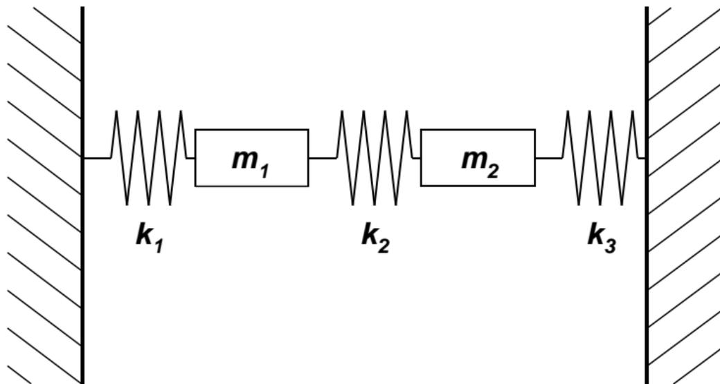
**Abbildung 6.8:** Zwei-Massen-Schwinger
